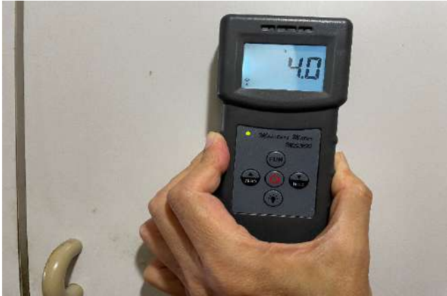
▲表面乾燥 パーティクルボード下地プラスチックフィルム貼り
